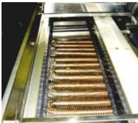
高効率フィンヒーター配置の予熱ゾーン
