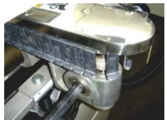
搬送コンベアにはハンダが付着しない樹脂爪を採用
